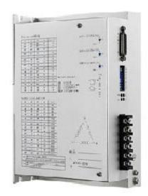
HB-3722MA 是基于 DSP 控制的三相步进电机驱动器。它是将先进的 DSP 控制芯片和三相逆变驱动模块结合一起所构成的新一代数字步进电机驱动器。驱动电压为 AC170V-260V,适配电流在 7A 以下、外径 85-130mm 的各种型号的三相混合式步进电机。该驱动器内部采用类似伺服控制原理的电路,此电路可以使电机运行非常平稳,几乎没有震动和噪音,在同等电压电流时,电机力矩高于二相和五相混合式步进电机。该产品广泛应用于木工雕刻机、数控机床、电脑绣花机、包装设备、陶瓷设备以及激光切割设备上。
